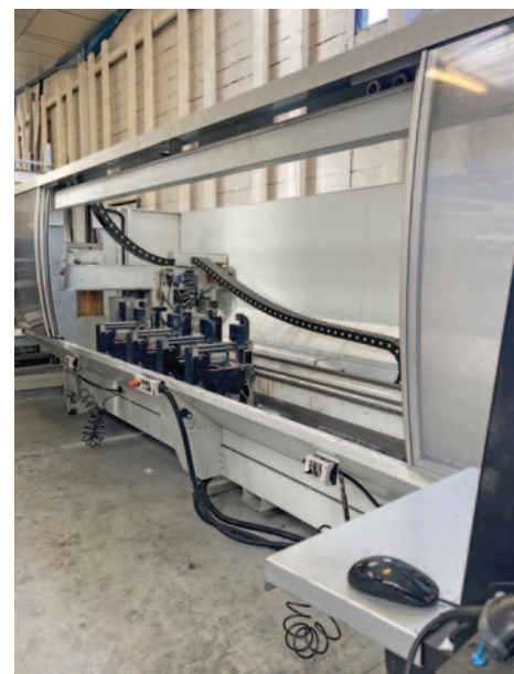
Centre d'usinage au sein de l'atelier de production de menuiseries aluminium.
